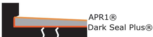
Para techos o losas de hormigón armado cuya estructura no incluya vigas, se aumentará el **consumo mínimo a 2.5kg/m2**.
